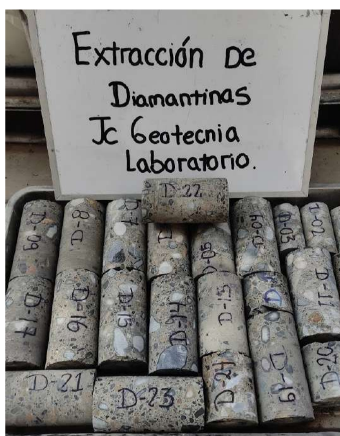
PROYECTO: EXTRACCIÓN Y EVALUACIÓN DE RESISTENCIA DE TESTIGOS DIAMANTINOS, PATIVILCA - BARRANCA.
